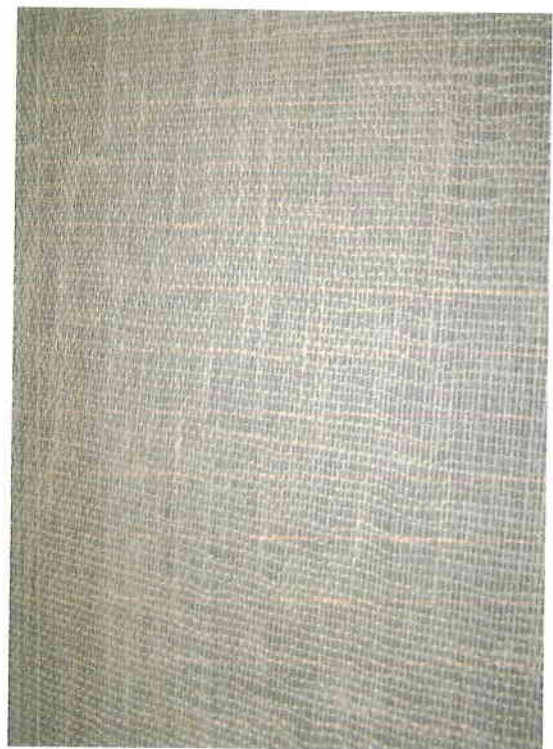
Рисунок 1 - Зовнішній вигляд зразка покриття для підлоги натурального в рулонах серії «Marmoleum» (з лицьової та внутрішньої сторін), виробництва Forbo Novilon B.V. (Нідерланди), яке було відібрано для сертифікації.
