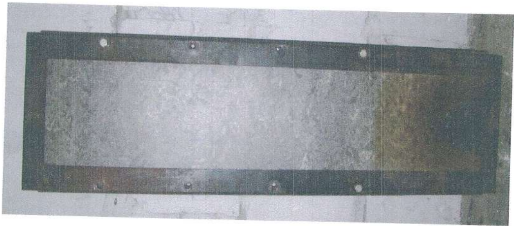
Рисунок 1 - Характерний вигляд зразка покриття для підлоги натурального колекції «Marmoleum», виробництва "Forbo Flooring B.V." (Нідерланди), після випробувань з визначення групи поширення полум'я згідно з ДСТУ Б В.2.7-70-98.
