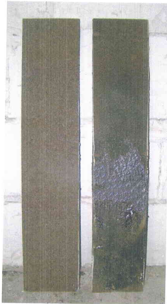
Рисунок 1 - Характерний вигляд зразка килимового голкопробивного покриття для підлоги з поліамідних волокон серії «Markant», виробництва "Forbo Sarlino S.A.S." (Франція), до та після випробувань з визначення групи горючості згідно з ДСТУ Б В.2.7-19-95.
