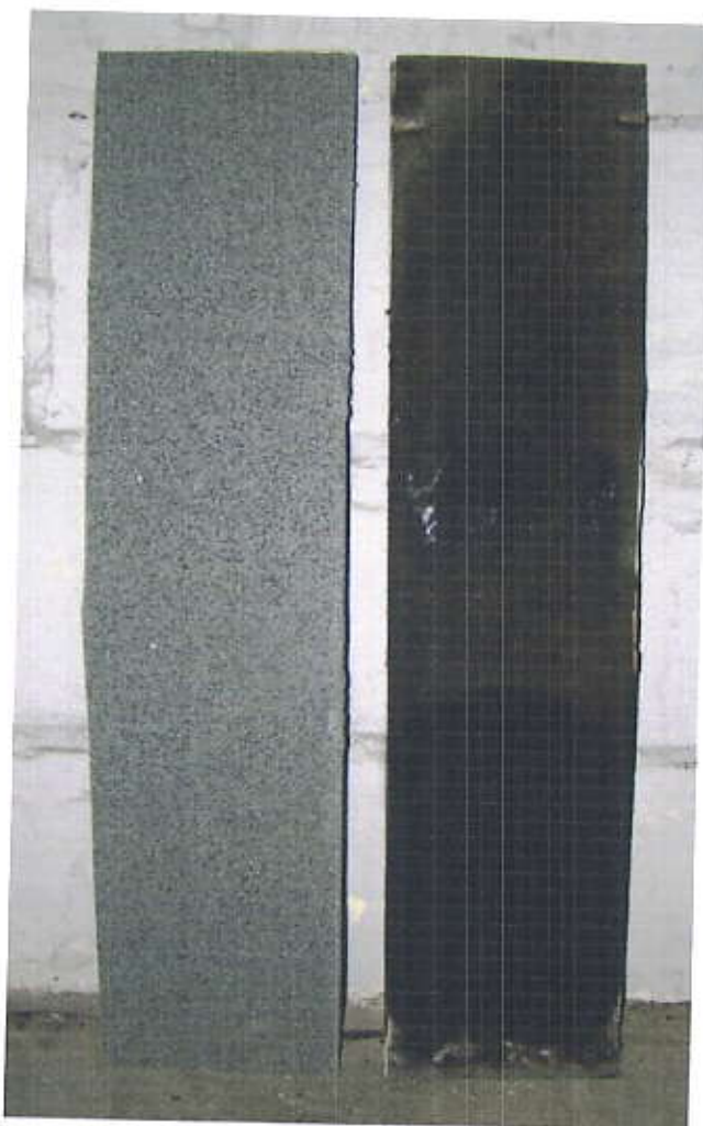
Рисунок 1 - Характерний вигляд зразків покриття для підлоги на основі гуми «Sportec Color 5 Grey», виробництва KRAIBURG RELASTEC GmbH & Co. KG". (Німеччина), до та після випробувань з визначення групи горючості згідно з ДСТУ Б В.2.7-19-95.
